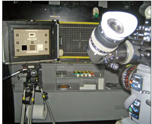
図4 ☒ 透過式テストパターンを使ったカメラ解像度テストの現場
