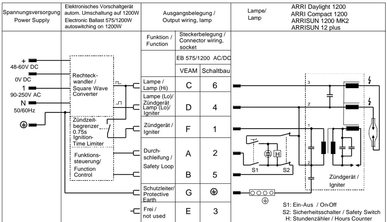
Abb./Fig. 1b: Anschlußbelegung 1200 W /
