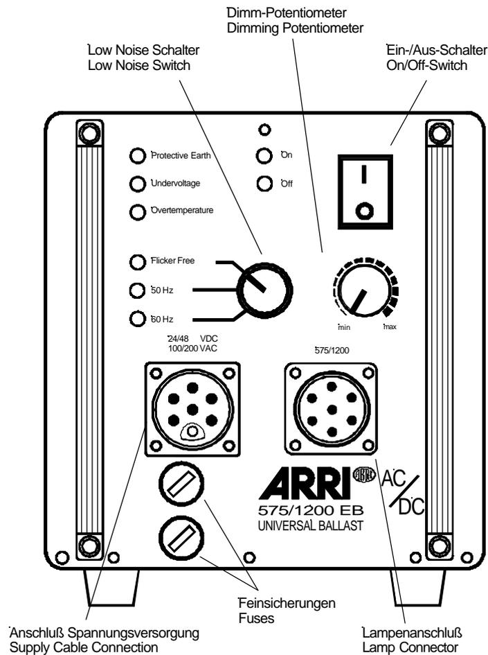
Abb./Fig. 2: Bedienelemente auf der Frontplatte
