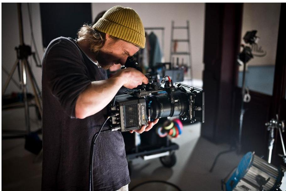
2018年に発表されたARRIのラージフォーマットカメラシステムは、35mmフォーマットの2倍の面積と2倍の解像度を持つ、4.5KバージョンのALEXAセンサーをベースにしています。このセンサーにより、ALEXAが従来持っている自然な色再現性、美しいスキントーン、低ノイズ性、ハイダイナミックレンジ(HDR)および広色域(WCG)ワークフローを維持したまま、ラージフォーマットならではのルックを収録できます。ALEXA Mini LFは、ハイスピード撮影が可能なALEXA LFカメラ、ARRI Signature Primeレンズシリーズ、LPLレンズマウント、PL-LPLアダプター、レンズデータシステムLDS-2などで構成されるARRIのラージフォーマットカメラシステムに参入します。これらの機能を兼ね揃えた大小2種類のラージフォーマットカメラにより、撮影現場におけるシステムの汎用性が格段に向上します。
