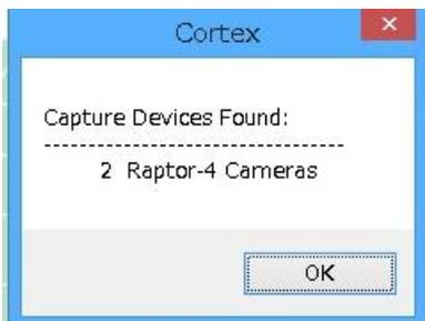
カメラを見つけるとカメラ名と接続した台数を表示します。また、カメラ以外のアナログ入力装置やフオースプレートが認識されると同時に表示されます。
