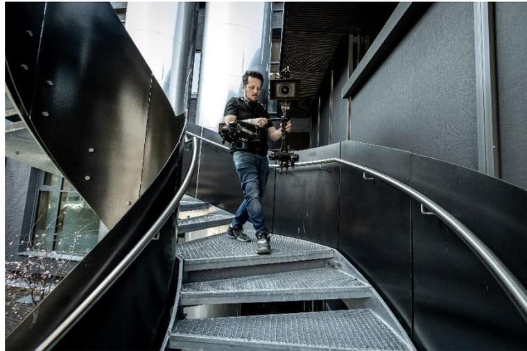
TRINITY 2 の機能を高水準化するに当たり、ARRI と技術パートナーである FoMa Systems は、オペレータからのフィードバックを多く取り込んでいます。次世代機では、レンズ軸での 360 度回転を含めた、新しいカメラワークを実現します。本体に LBUS コネクターが追加されたため、ARRI スタビライズドリモートヘッド用コントローラによるデジタル運用や、新型 LBUS コントローラ Master Grip TRINITY による指先での機能操作が可能となりました。高速プロセッサを備えたタッチスクリーンリモートコントロールは、スタンドアロンでシステムを起動できるため、現場でのパラメータを調整できます。また、アクセサリインタフェースの追加によるリギングの選択肢拡大や、12G-SDI 接続対応によるモニタリング能力向上も特徴です。
