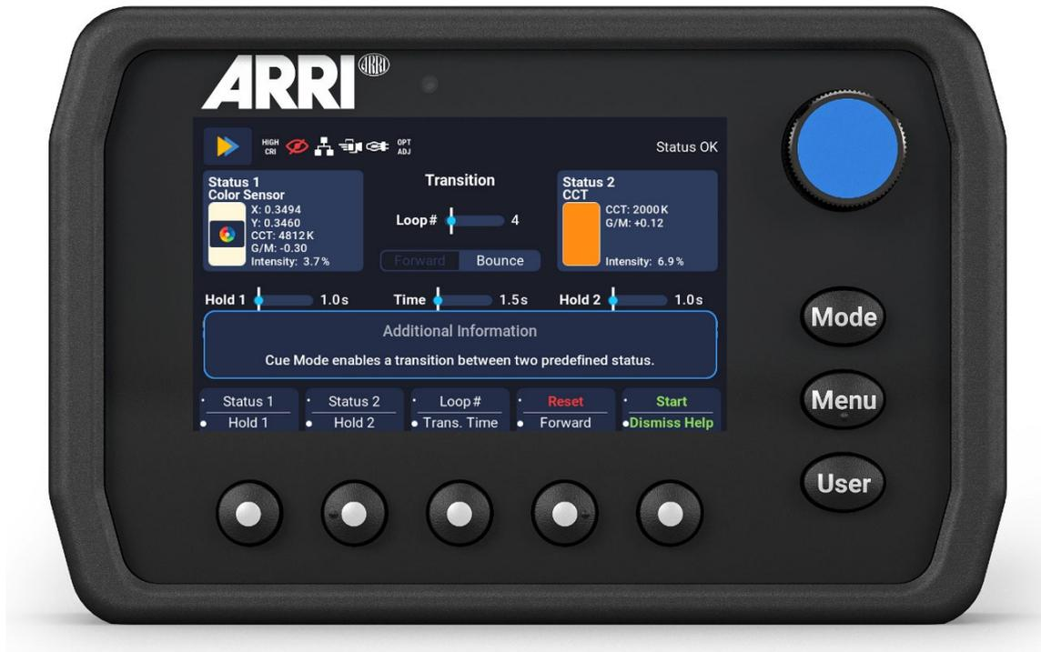
Optics Auto Adjust Mode は、光学系やフォーカスの影響による色の変動を 100%おさえます。QLM (Quick Lighting Mount) は、装着されたアクセサリを判別できるため、ソフトボックス、ドーム、オープンフェイスリフレクター、フレネルレンズのどれが装着されていても安定した色を出力させることができます。また、フレネルレンズを使用した場合、ズームレンジ全体にわたって色を安定させます。これにより、カメラクルーは他の設定に集中することができます。
